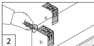
Träger befestigen an: a Decke; b Wand
