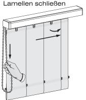
durch Zug an der Bedienkette wenden die Lamellen komplett und fahren anschließend zu
