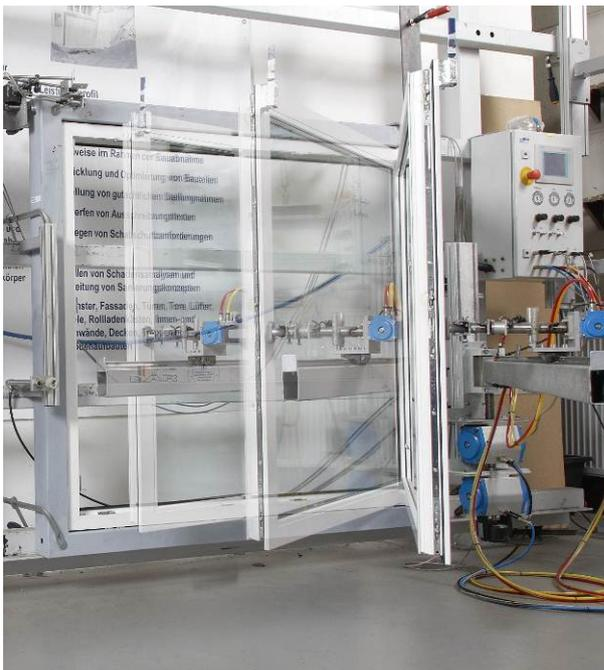
**Bild 4** Prüfung der Dauerfunktion (Bild: ift Rosenheim)
