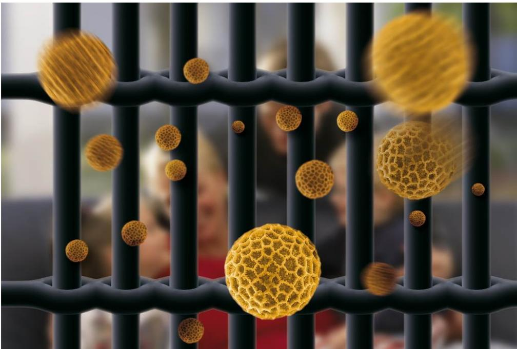
**Bild 8** Wirkweise eines Pollenschutzgewebes, das durch elektrostatische Aufladung Pollen geradezu „anzieht“ (Bild: Neher)
